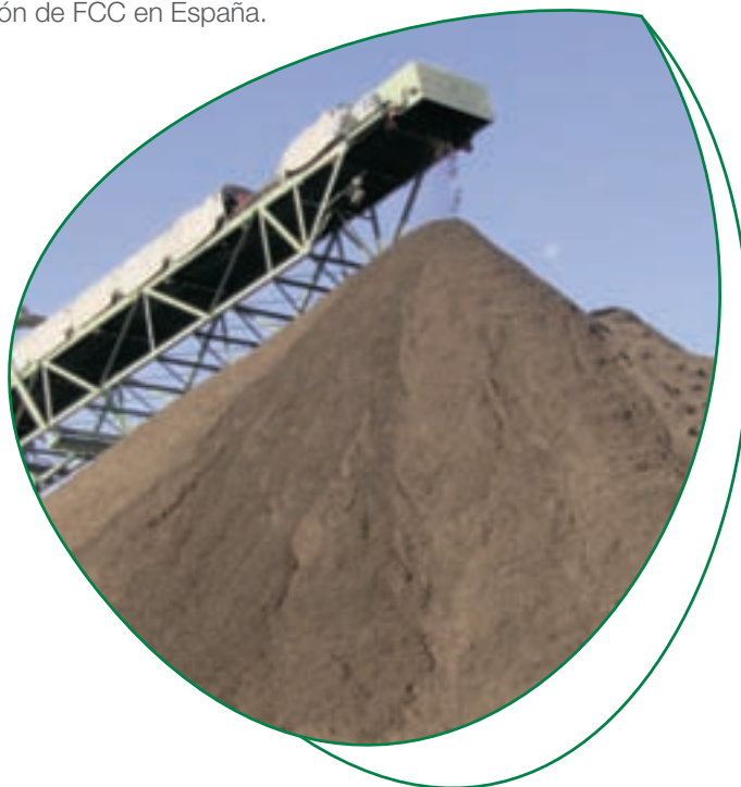
Salida de la línea de afino (Planta de Tratamiento de RSU de Valladolid)
