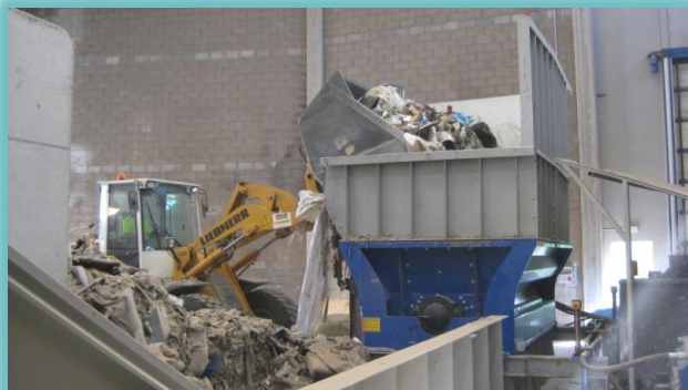
Planta de Preparación de Combustible para Cementera (CDR) a partir de Residuo Industrial
